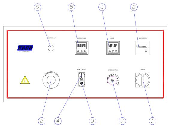
**Тумблер выключателя** (1): "0" обозначает выключение, а "1" - включение. Дверцу панели управления можно открыть только в положении "0".
