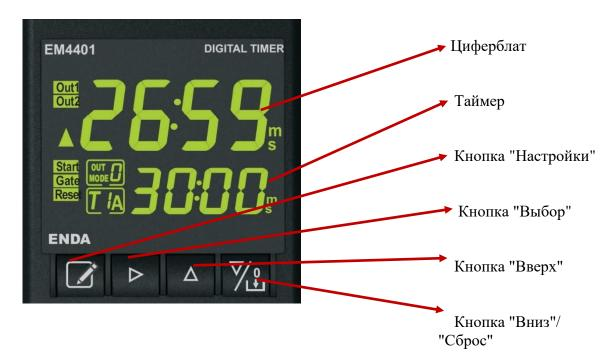
Настройка таймера: Нажмите кнопку «настройки» один раз, дождитесь, пока цифры замигают. Используйте кнопку «выбора» для выбора цифры, используйте стрелки «вверх» или «вниз» для изменения значения времени. Подождите 3 секунды, пока на таймере появится новое время, после чего, нажмите кнопку "Вниз" / "сброс", чтобы сохранить заданный параметр.
